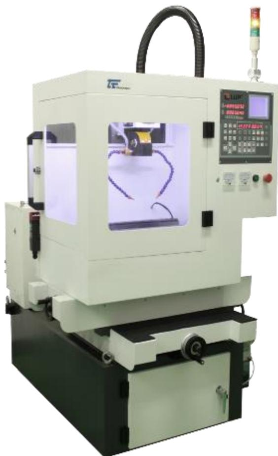
加工液の高圧噴射に対応した全閉式高速加工機。
